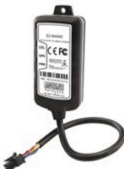
Der **kompakte GPS Tracker** mit integrierten GPS-GSM-Antennen, im wasserdichten IP-Gehäuse, wird direkt an Plus (KL30), Minus (KL31) und Zündung (KL15) im Fahrzeug und KFZ angeschlossen. Die GPS Ortung erfolgt in Echtzeit bei Zündung EIN oder bei Bewegung.
